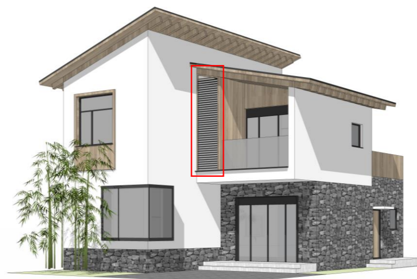
5) 空调机位结合建筑内凹阳台布置
